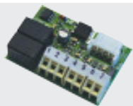
B EBA IO DRIVER - P111466 Tarjeta de expansión INPUT/OUTPUT
